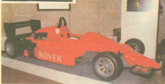
«Эстония-25», оснащенная двигателем «Ровер-К16-1,4МР1» с впрыском топлива и двумя распределительными валами. Он весит всего 98 кг — на 42 кг легче «жигулевского».
